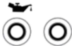
当曲轴箱内机油不足时,机油保护系统会自动关闭发动机,机油报警指示灯(黄灯)闪烁,机油注满到油位后,发动机才能重新启动
